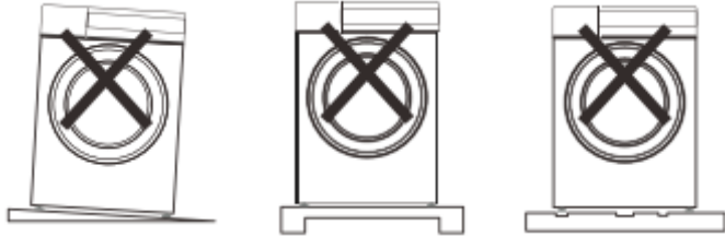
1. Trên mặt đất dốc 2. Trên bệ và giá trên mặt đất 3. Trên mặt đất không bằng phẳng
